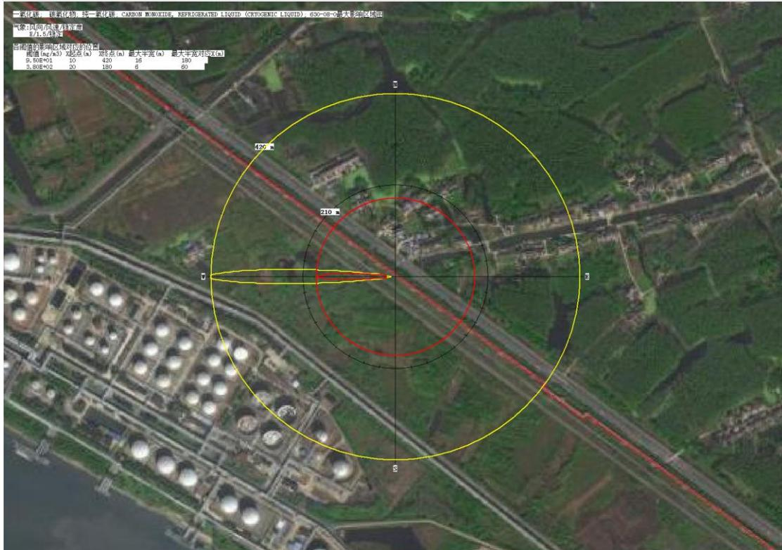
图 6.3-3 最不利气象条件下风向 CO 大气毒性终点距离图 (mg/m<sup>3</sup>)
