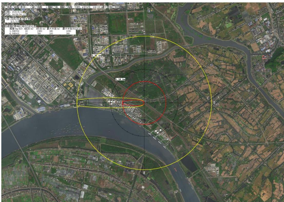
图 6.3-1 最不利气象条件下风向醋酸乙烯酯大气毒性终点距离图 ( $\text{mg}/\text{m}^3$ )
