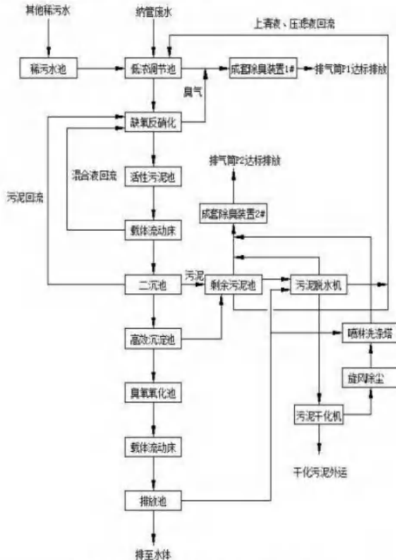
图 7.2.2.4-1 博瑞德水务工艺流程图
