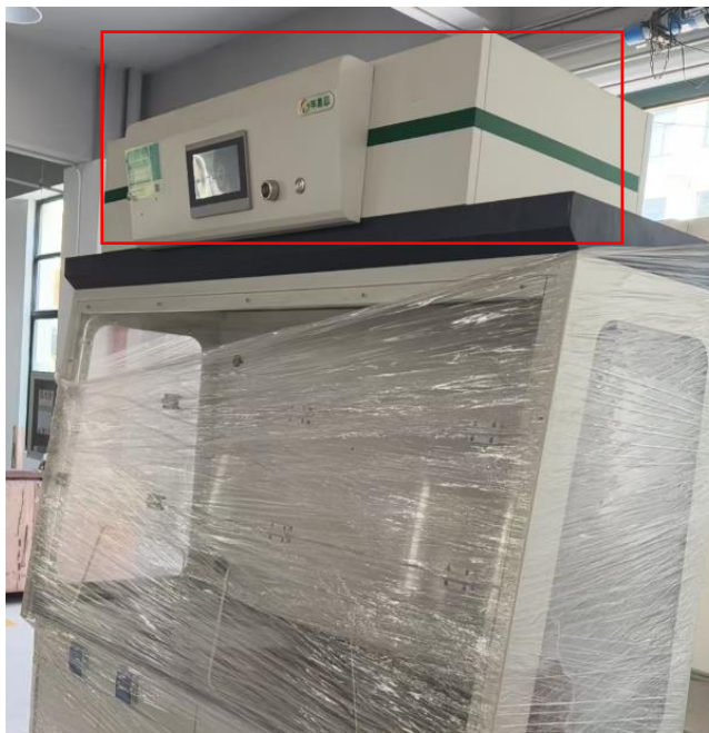
图 4-1 通风橱顶部配套的净化系统照片
